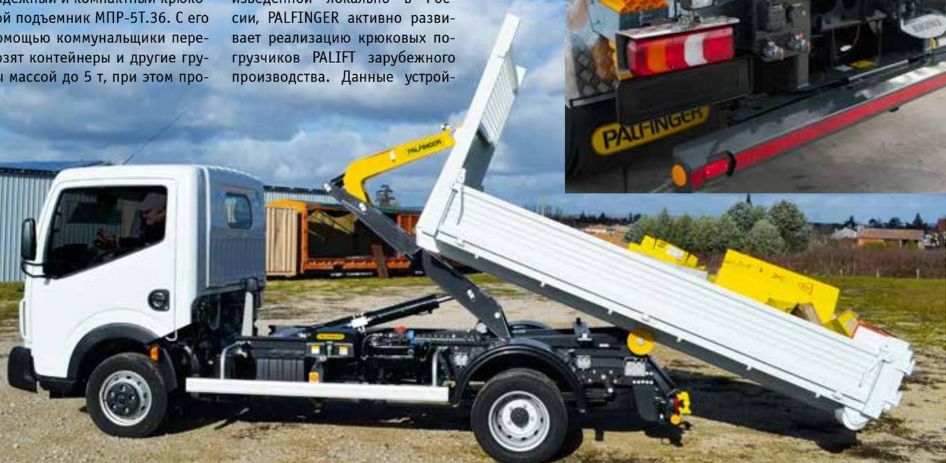
серии является возможность безопасной погрузки контейнеров, расположенных очень близко к машине и даже находящихся значительно ниже уровня базового шасси.
