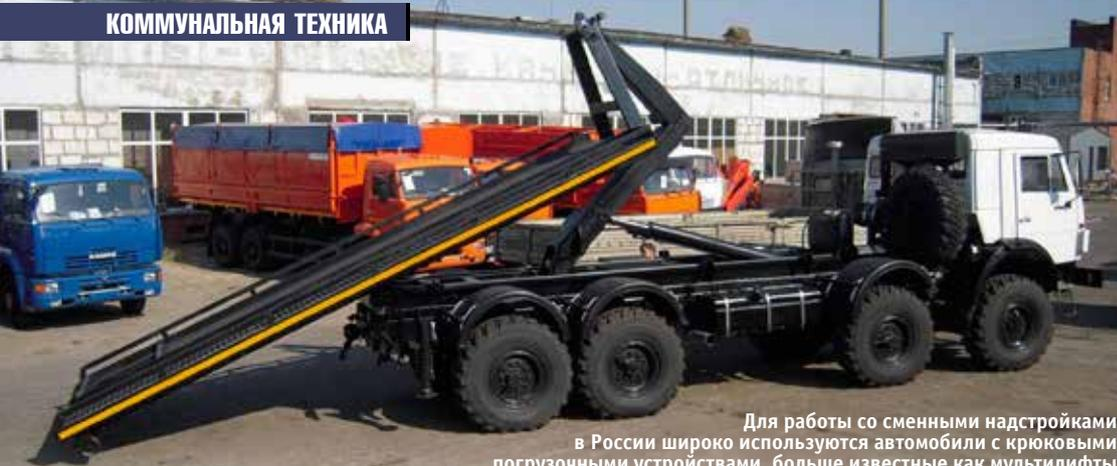
Для работы со сменными надстройками в России широко используются автомобили с крюковыми погрузочными устройствами, больше известные как мультилифты
