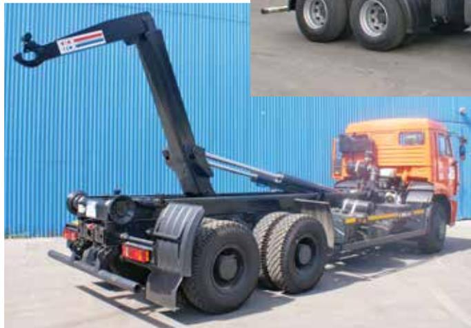
Для более тяжелых и высоких шасси (от 12 т) подходят модели г/п от 8 до 40 т, с высотой крюка 1570 мм под контейнеры длиной от 3,5 до 8 м.
