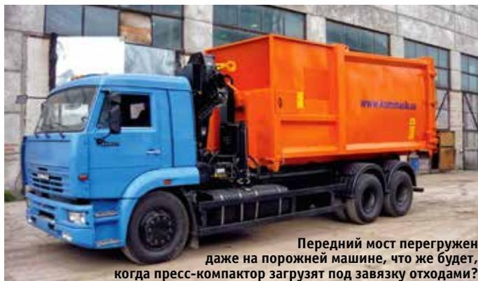
Передний мост перегружен даже на порожней машине, что же будет, когда пресс-компактор загрузит под завязку отходами?
