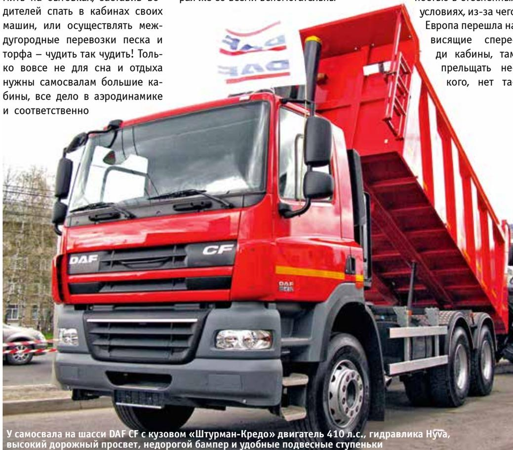
У самосвала на шасси DAF CF с кузовом «Штурман-Кредо» двигатель 410 л.с., гидравлика Нува, высокий дорожный просвет, недорогой бампер и удобные подвесные ступеньки
