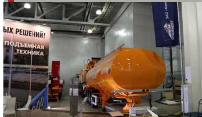
значены для использования в составе автопоезда с седельными тягачами с колесной формулой 4×2 или 6×4 (6×2). Полуприцепы-цистерны Sobo могут использоваться в самых сложных температурных условиях от –45 до +50 °С, они проходят все необходимые испытания, что подтверждается специальным сертификатом.
