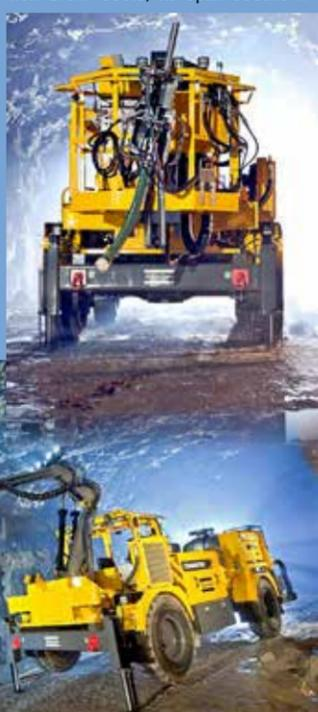
обработку мощными гидромолотами с одного места 84 м<sup>2</sup> (12×7 м) кровли и бортов подземной выработки. Внешний радиус поворота машины – 6,6 м.
